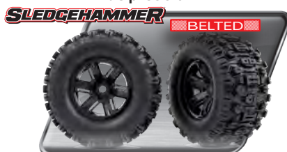
Neumáticos radiales Sledgehammer® sobre ruedas negras X-Maxx®
